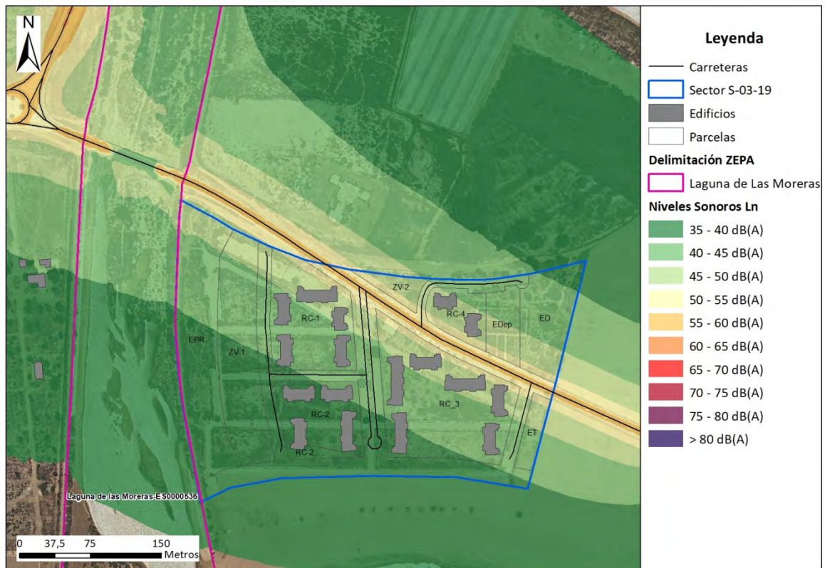
Ilustración 19. Niveles sonoros en periodo Noche en el ámbito de estudio. Escenario Operacional
